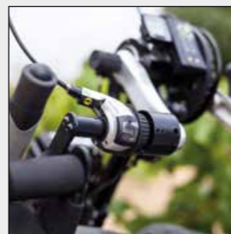
Sistema di cambio per tetraplegici BATEC SHIFT LEVER (Brevettato)**: può essere attivato facilmente senza togliere le mani dalle manopole.
