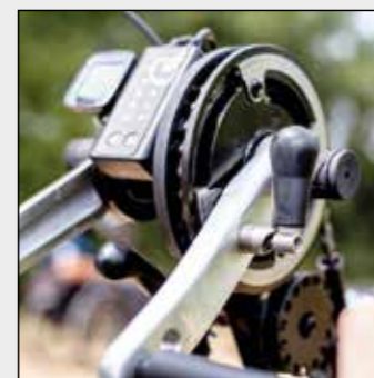
Sistema di sgancio bielle BATEC MAGIC LEVER (Brevettato)***: offre un modo di accensione assistita e permette agli utenti di usare il Batec con zero sforzo.
