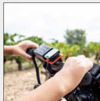
Manubrio Gas & Brake senza manette*: permette di accelerare e frenare con leggeri movimenti del manubrio.
